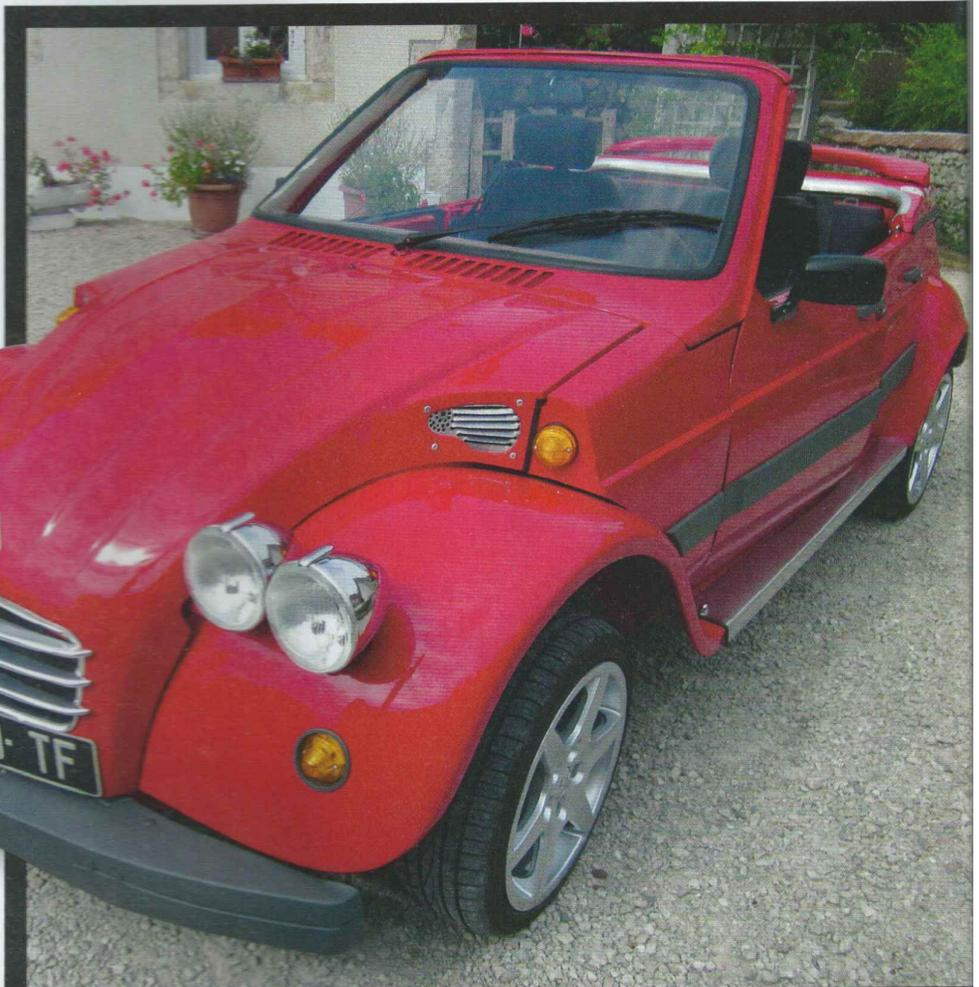
En partant d'une 2 CV en mauvais état et d'une Visa bonne pour la casse, Michel Vrignaud a pensé, dessiné et réalisé la Deuche Visa, un cabriolet quatre portes-quatre places utilisant les éléments des deux modèles.
